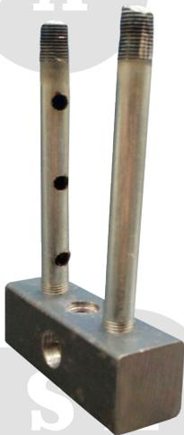
**SISTEMA DE RIEGO DOBLE DESMONTABLE,** Facilita su limpieza, y mantiene lubricadas las dos caras del disco.
