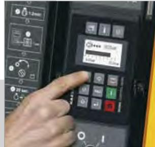
La presión del compresor puede ajustarse con una exactitud de hasta 1.5 psig accionando simplemente las teclas con flechas que se encuentran en el cuadro de mandos del SIGMA CONTROL mobil. Esta posibilidad, unida a la regulación electrónica de la válvula de admisión, significa una mayor flexibilidad en el uso del compresor y un gran ahorro de combustible, sobre todo en carga parcial.
